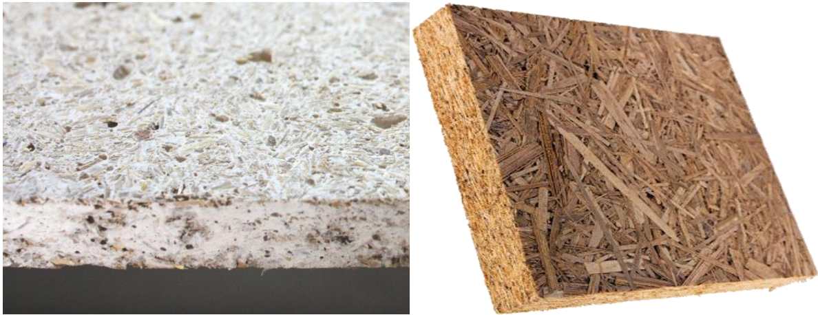
Abb.2: Brandschutzplatte mit Schilf, Dämmplatte aus Rohrkolben (Fotos: C. Schröder; www.typhatechnik.com ).
